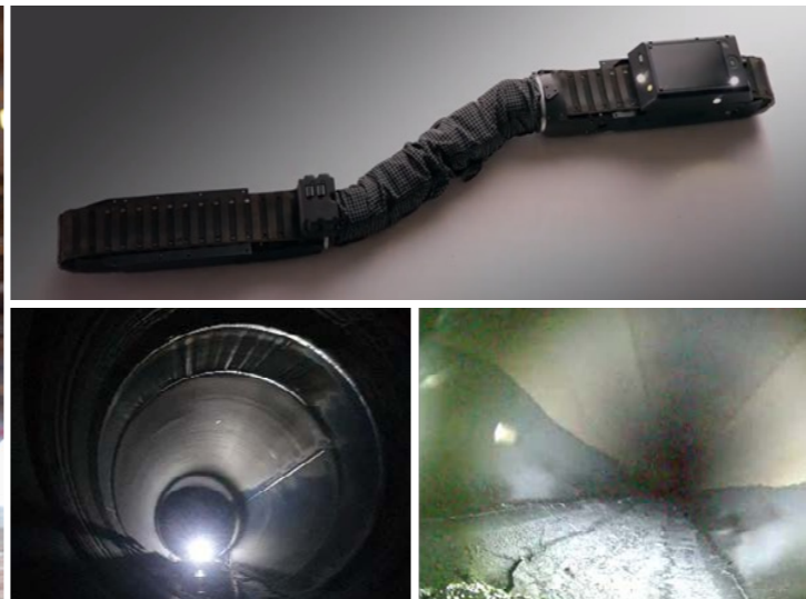
SK이노베이션 울산Complex, 배관 내부 검사 ‘Guardian-S(로봇 뱀)’ * 해당 이미지에 대한 copyright는 Sarcos에 있음
